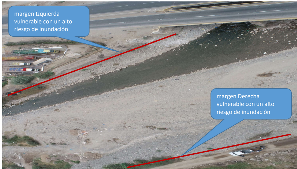
FIGURA N°02: MATERIAL COLMATADO EN EL CAUCE DEL RÍO CHANCAY-HUARAL, CON UNA PROFUNDIDAD PROMEDIO DE 1.0 M Y DIQUE DETERIORADO. ESTO PROVOCA QUE DESBORDAMIENTO DEL RÍO SEA MAS INMINENTE.
